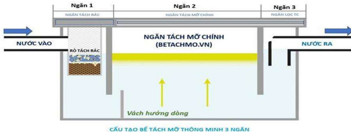
Hình 3. 4. Cấu tạo bể tách dầu
